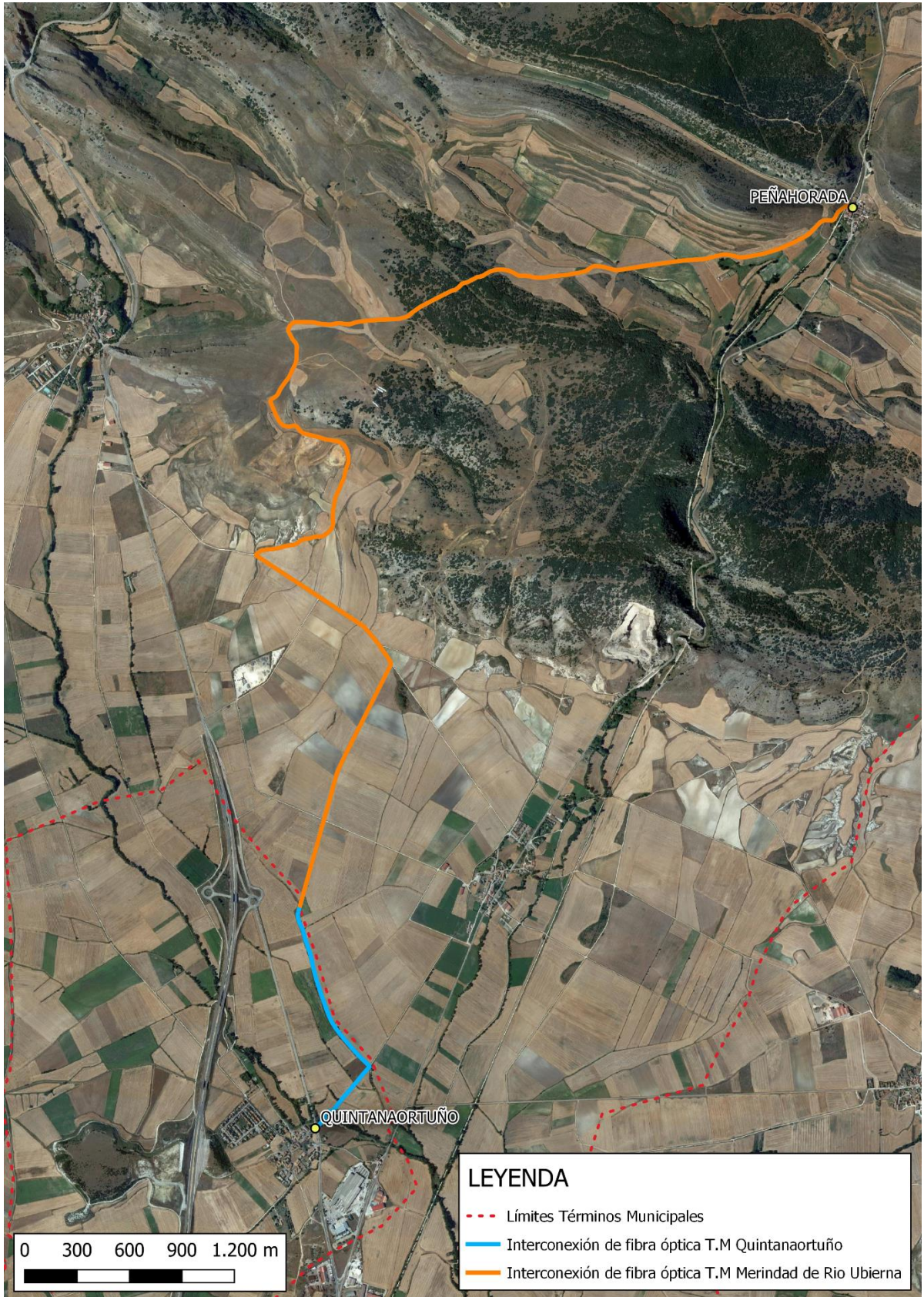
Figura 1. Trazado de la instalación.
