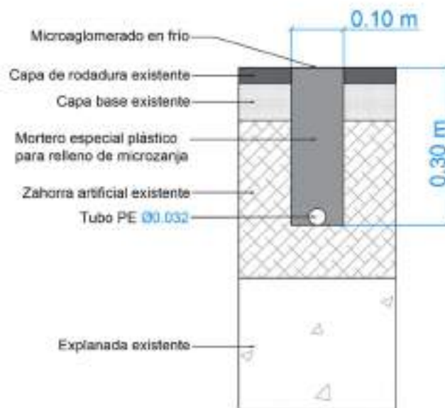
Figura 5. Esquema de microzanja en pavimento.
